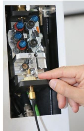
Drahtfördereinheit mit 4-Rollen-Antrieb des Drahtfördersystems MFS-V3 von ABICOR BINZEL in der Laserzelle TruLaser Weld 5000
