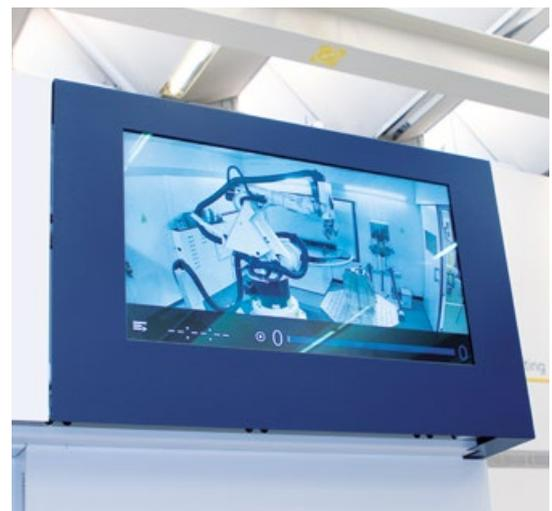
Monitor mit Blick ins Innere der Laserzelle TruLaser Weld 5000
