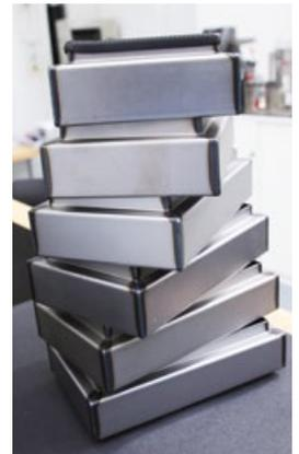
Anschauliche Musterteile zur Visualisierung von konstruktiven Änderungen für eine perfekte Naht geschweißt mit der Ausstattungsvariante FusionLine von TRUMPF in der Laserzelle TruLaser Weld 5000
