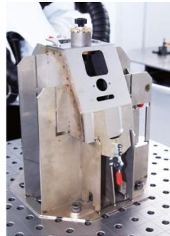
Bauteil für das Wärmeleit-schweißen und Tiefschweißen in der Laserzelle TruLaser Weld 5000
