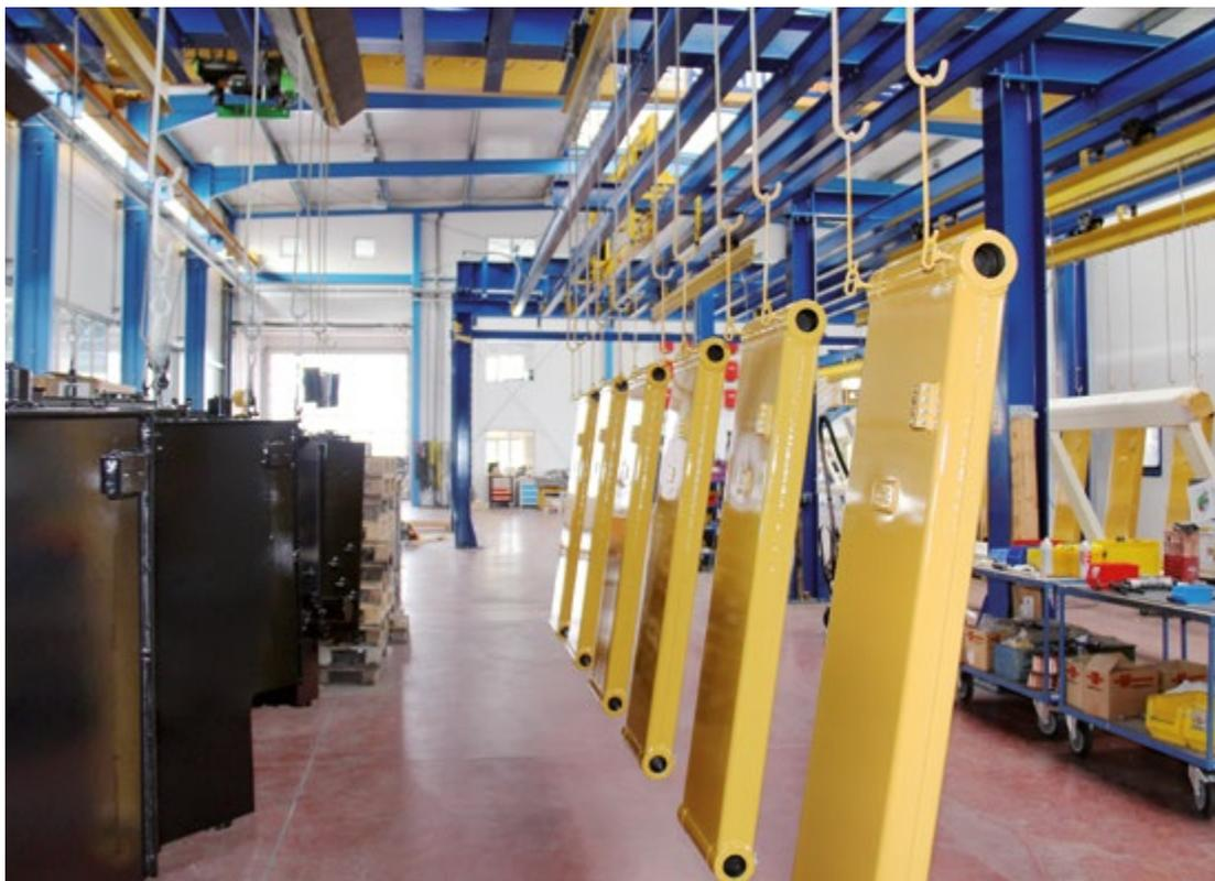
**Ausleger für höhenverstellbare Führerhäuser von Baggern in der Lackiererei von Stahl Maschinenbau**
