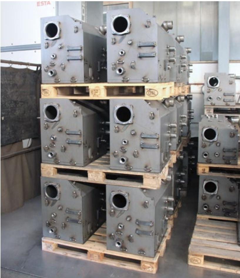
Fertige Hydrauliktanks bereit zur Auslieferung
