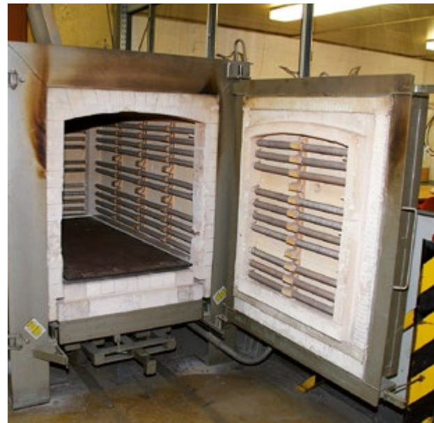
Wärmebehandlungs-ofen zum langsamen Abkühlen von vorher wärmebehandelten, geschweißten Stahlteilen
