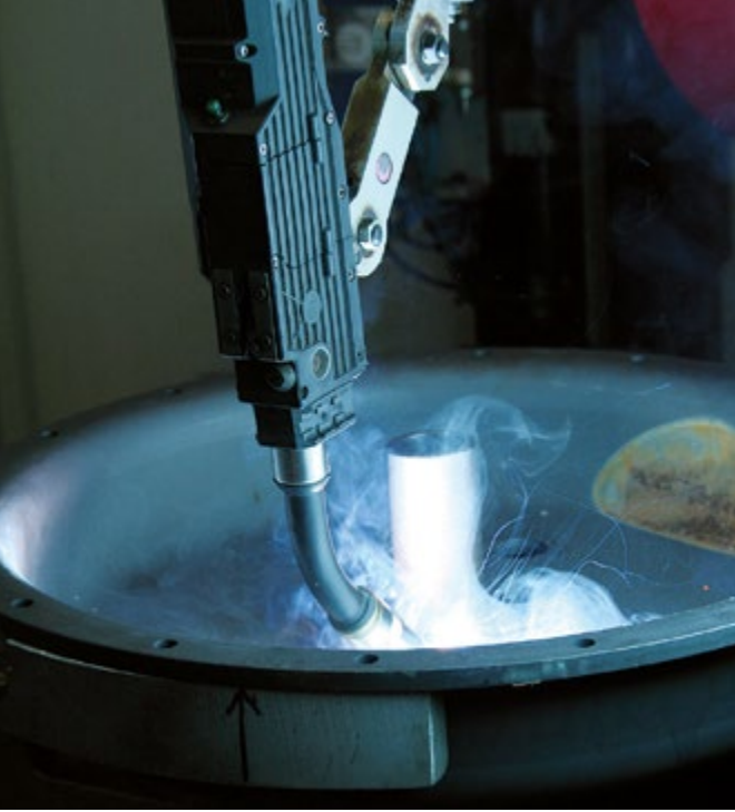
... der Mittelbuchse auf ein Antriebsdeckblech erfolgt von beiden Seiten mit Drehung der Roboterachse, Roboterbrenner WH W 500
