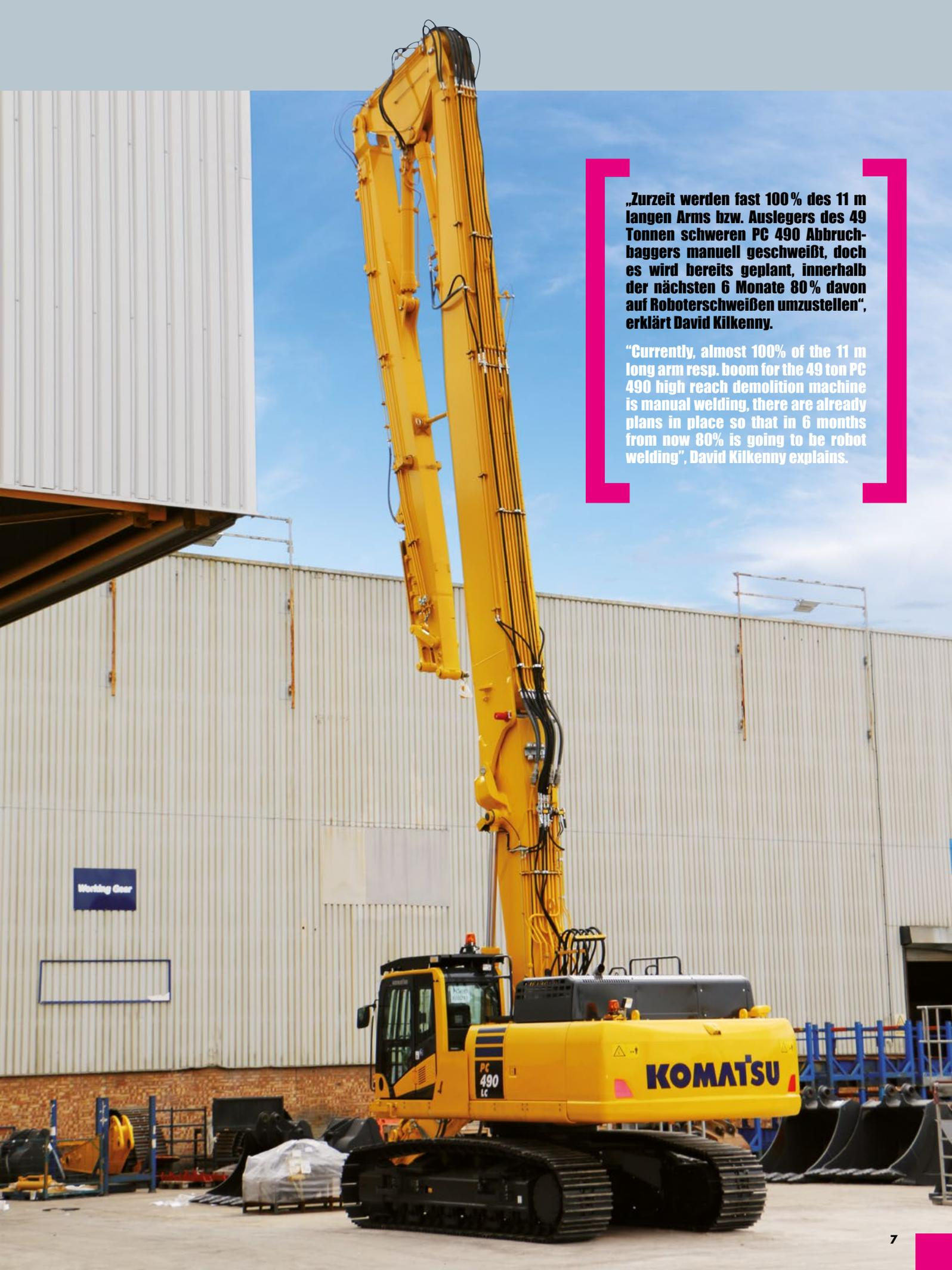
**„Zurzeit werden fast 100% des 11 m langen Arms bzw. Auslegers des 49 Tonnen schweren PC 490 Abbruchbaggers manuell geschweißt, doch es wird bereits geplant, innerhalb der nächsten 6 Monate 80% davon auf Roboterschweißen umzustellen“, erklärt David Kilkenny.**
