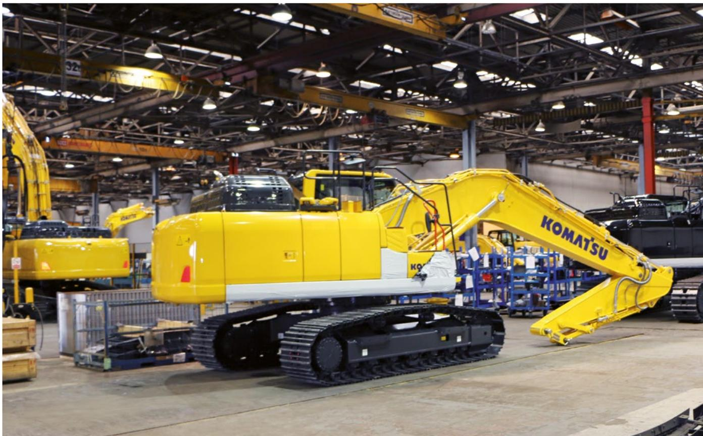
verschweißt wurde, halten wir an, um uns die Endkontrolle in einem speziell gekennzeichneten Bereich anzuschauen. Dabei können wir eine festgelegte Vorgehensweise beobachten, der der Mitarbeiter in der Fahrerkabine folgt. Vom Fahren, über das Bremsen und Wenden, bis hin zum Heben der Baggerarme werden nach bestimmten Vorgaben alle Grundfunktionen der Komatsu-Maschine auf Herz und Nieren geprüft.
