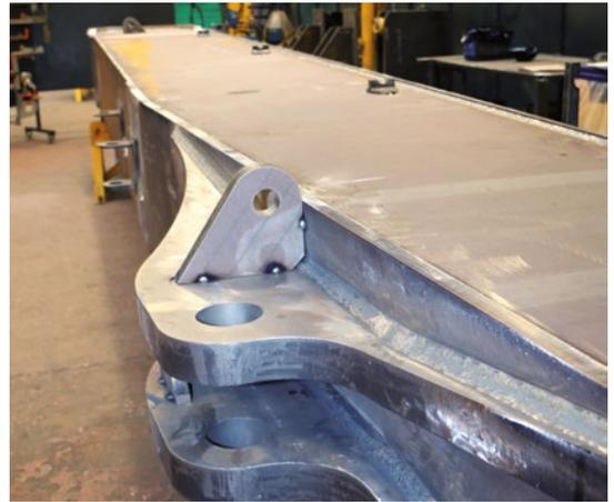
11 m langer Ausleger der Abbruchmaschine PC 490
