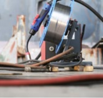
ABIMIG® A T LW Brenner mit dreh- und wechselbarem Brennerhals
