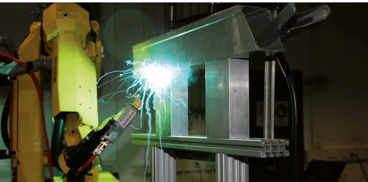
Über-Kopf-Schweißen von Aluprofilen im Doppel-Puls-Verfahren
