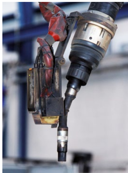
Schweißnaht, geschweißt unter Einsatz des TH6D Nahtsuch-sensors von ABICOR BINZEL
