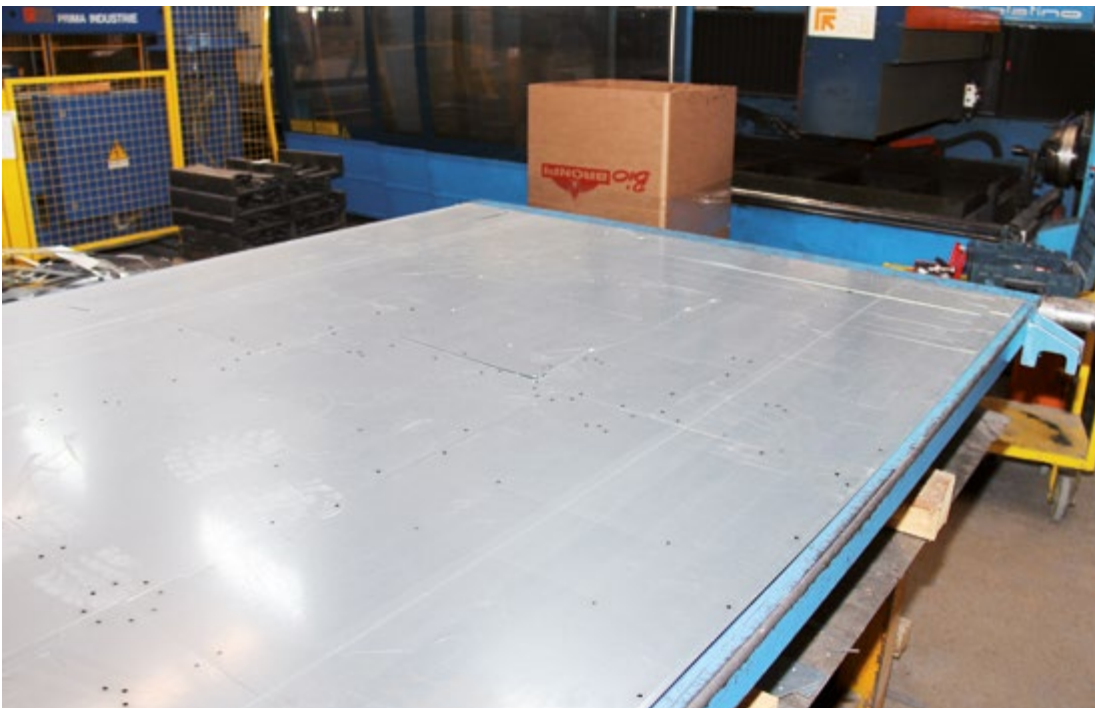
Schlichte Metallplatten aus denen alle Einzelheiten eines Kaminofens hochpräzise geschnitten wurden
