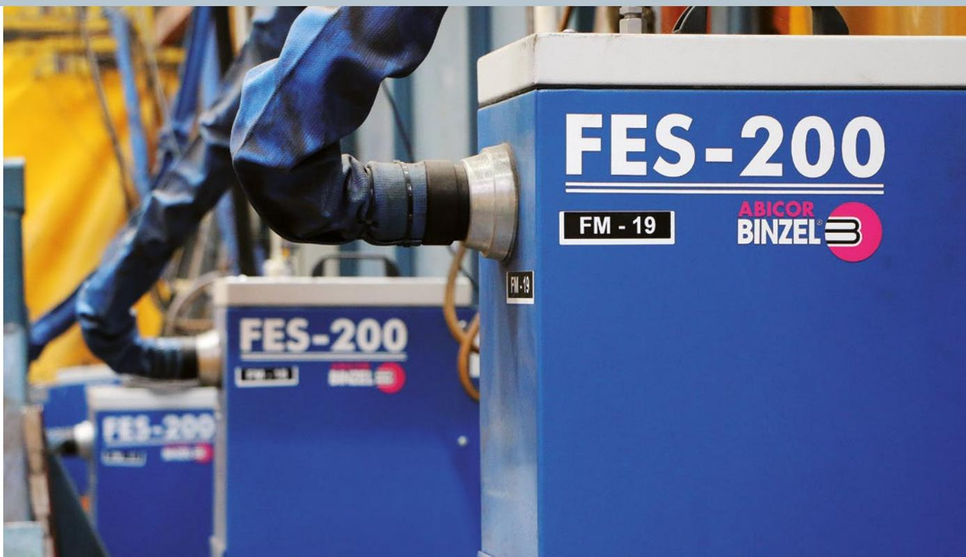
tion bewegliche Kräne haben und die Schweißzellen mobil sein müssen, um flexibel in der Fertigung zu bleiben“, kommentiert Lau Wai Pan. Die acht FES-Geräte im Bereich Teleskopträger und die zwölf Geräte in der Haupttrahmenproduktion sind auf beweglichen Trägern in den Schweißzellen befestigt oder an Wänden platziert, die die Produktionshalle in zwei Bereiche aufteilen.
