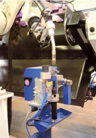
**Brennerreinigungsstation BRS-CC – die Komplettlösung für eine zuverlässige, automatische Wartung des Brennerkopfes**
