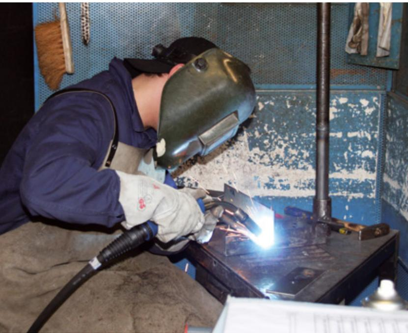
ihrer täglichen Arbeit weniger belastet. Das Gewicht konnte im Wesentlichen durch den Einsatz von Leichtmetall-Komponenten bei den stromführenden Kabeln im Schlauchpaket reduziert werden, wo das sonst übliche Kupfer durch Leichtmetall-Komponenten substituiert wurde. Trotz des verringerten Gewichts sind die Schweißbrenner voll industrietauglich und erfüllen die gängigen Normen und Regelwerke, insbesondere die DIN /EN 60974-7.
