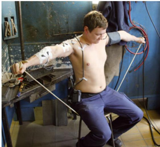
Intensive Vorbereitung: Aufbringen der Elektroden für die EMG – Messung, Aufwärmübungen und Maximalkraftmessung
