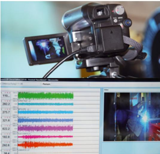
Messung der Muskelaktivitäten mittels kabellosem 8-Kanal Elektromyographie (EMG)
