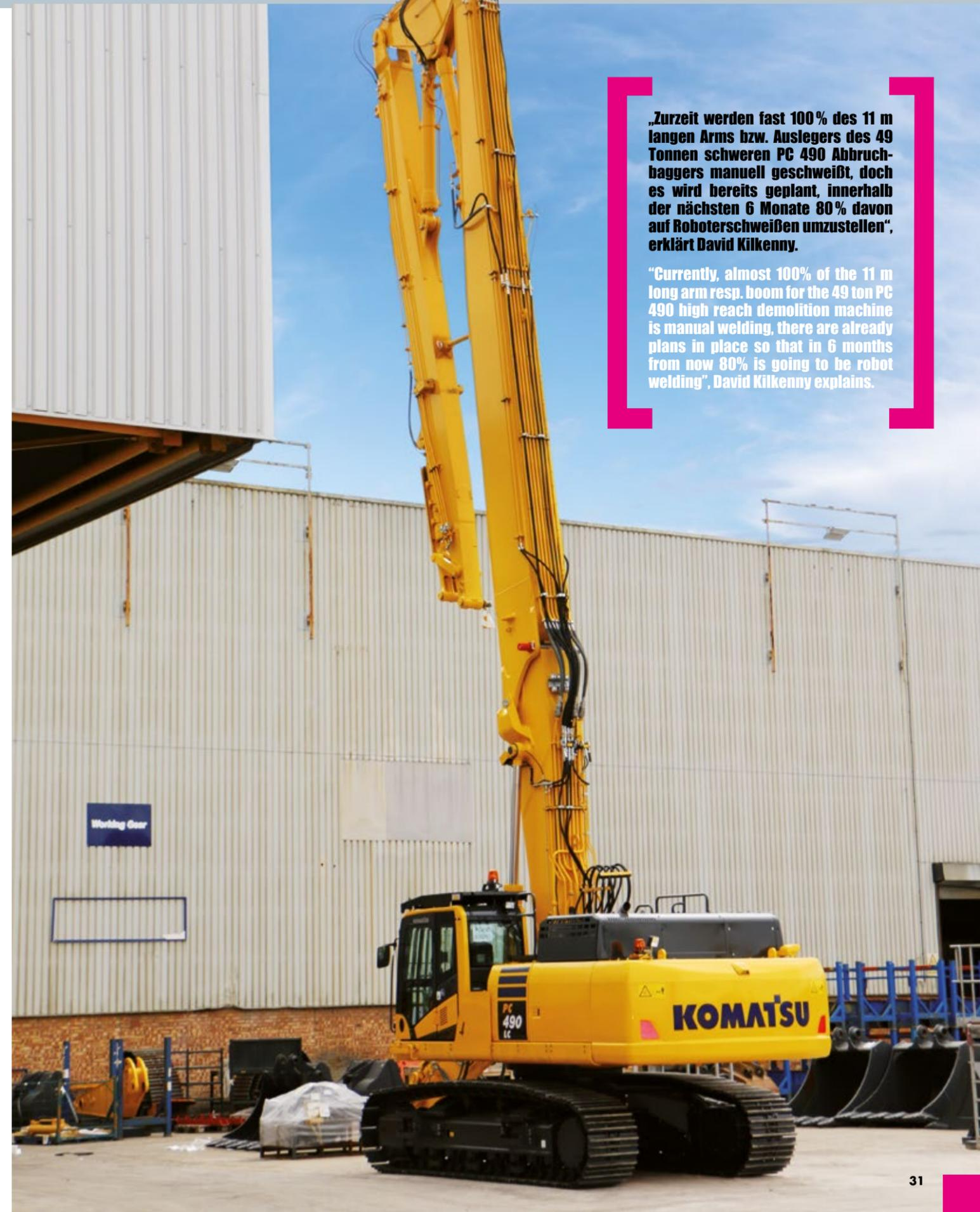
„Zurzeit werden fast 100% des 11 m langen Arms bzw. Auslegers des 49 Tonnen schweren PC 490 Abbruchbaggers manuell geschweißt, doch es wird bereits geplant, innerhalb der nächsten 6 Monate 80% davon auf Roboterschweißen umzustellen“, erklärt David Kilkenny.
