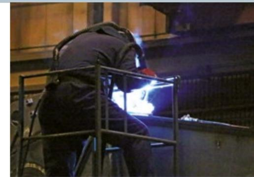
Schweißbrenner RB 610 von ABICOR BINZEL in Aktion
