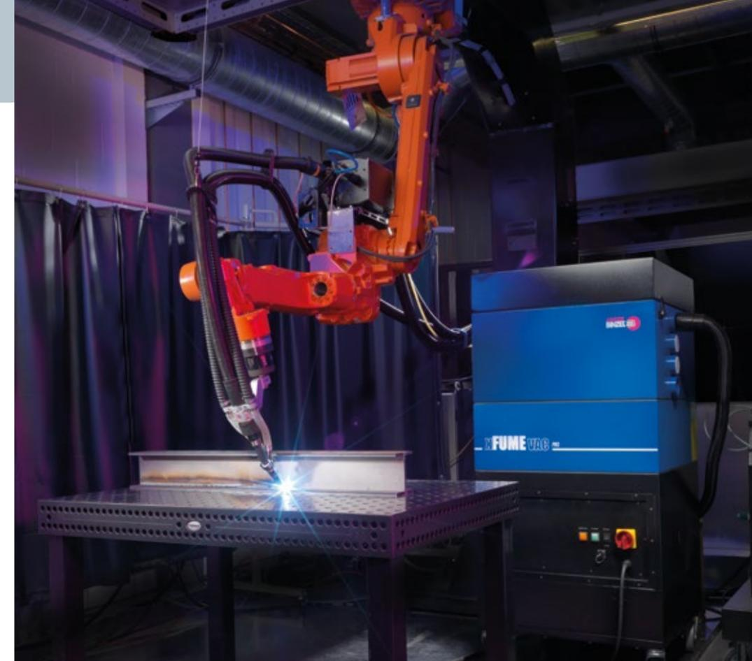
Saubere Luft auch in der Roboterzelle: xFUME VAC PRO und xFUME ROBO Absaugkit
