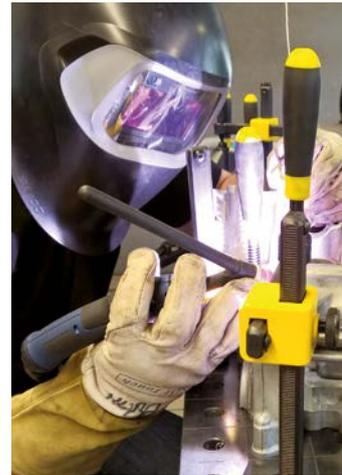
**Jakub Lerch beim Umschweißen des Kurbelwellengehäuses für Leichtbaumaßnahmen**
