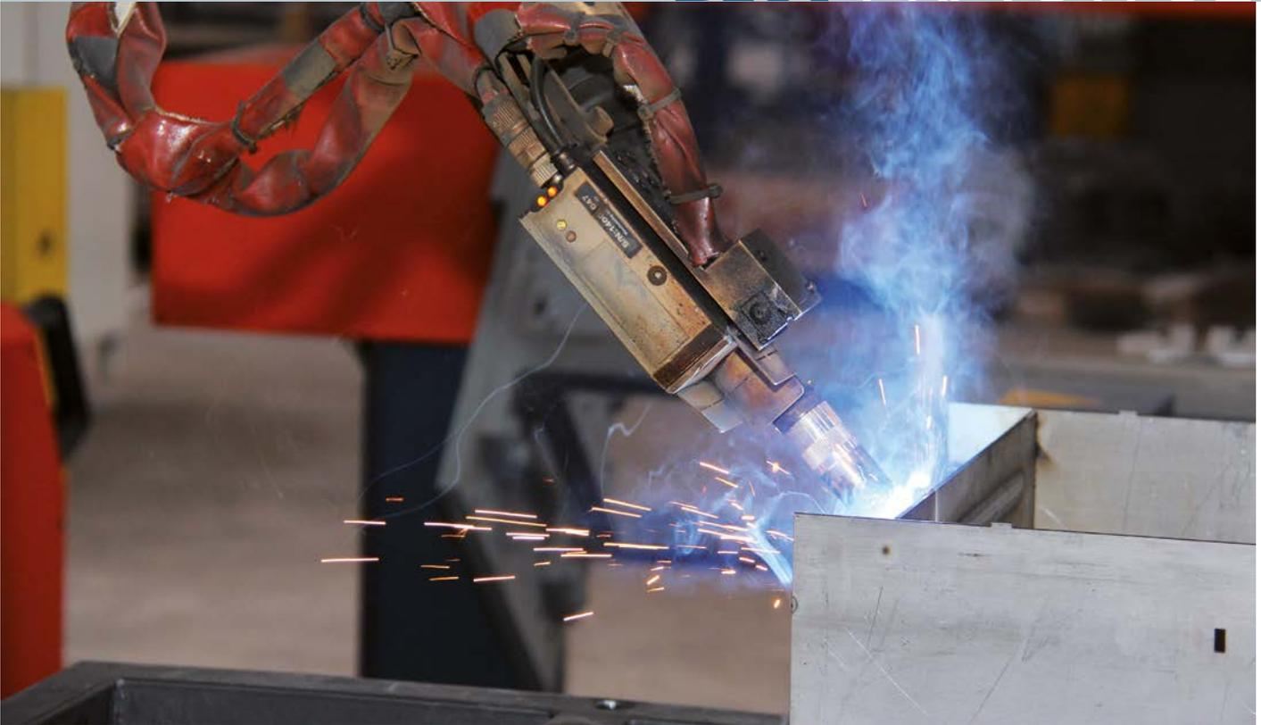
führungssensor TH6D in Verbindung mit dem Prozessrechner des TH6D und der Robotersteuerung als „Gehirn“ sind die Kanten der Bauteile.
