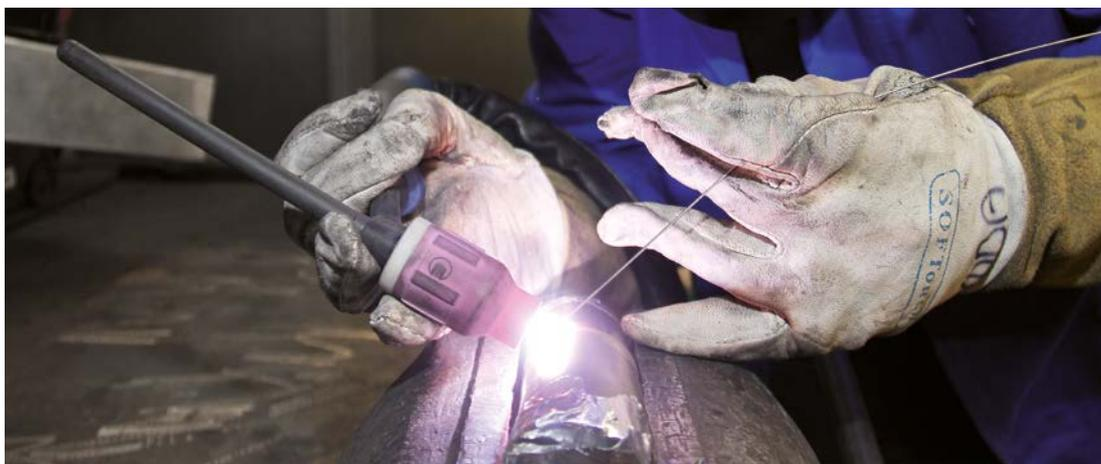
**Anschweißen der Buchse für Lambdasonde am Krümmer des RP15c**
