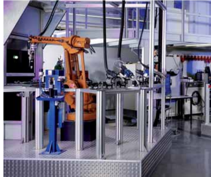
Auch beim Roboterschweißen erfolgen alle Tests unter praxisnahen Bedingungen.
