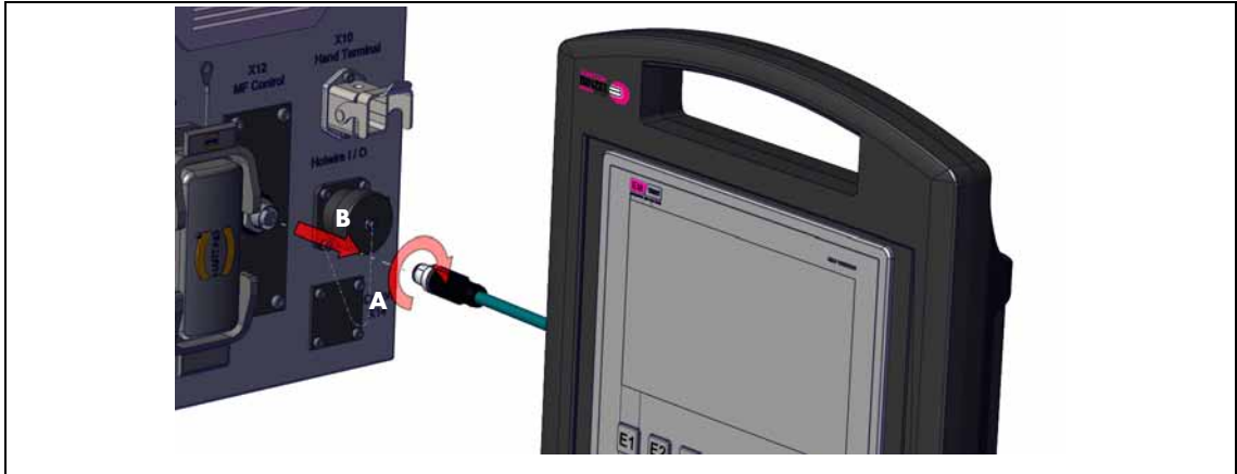
Abb. 5 MF Control demontieren
