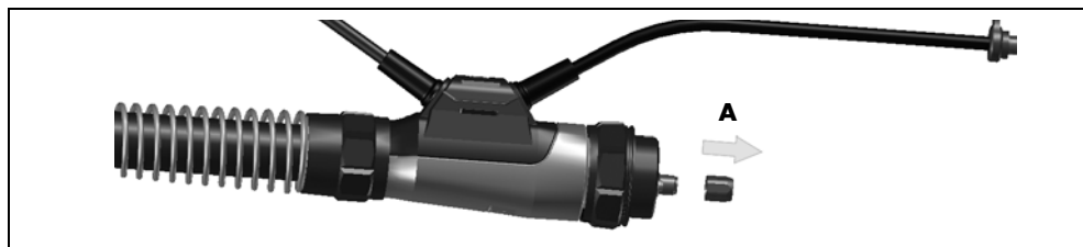
Фиг. 5 Отстраняване на холендровата гайка
