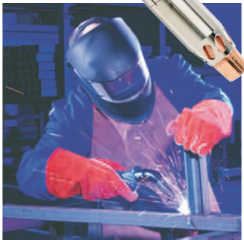
Uchwyt RAB GRIP z włączonym układem odciągu dymów spawalniczych
